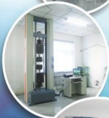
2、伺服控制电脑系统拉力试验机 (100KN) Servo Control System Universal Testing Machine
